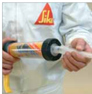
Se limpia la salida y se coloca la boquilla.
