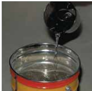
Vertido del agua de amasado en el producto.
